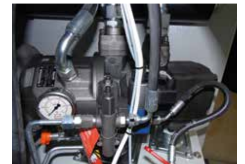
Unidade de controlo hidráulica
