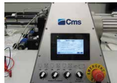
Controlo eletrónico da pressão de corte
