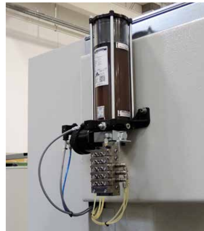
Lubrificação automática de todos os eixos (std)
