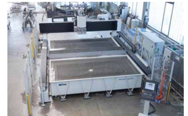
Versão com tanque duplo para processamento pendular (opc)
