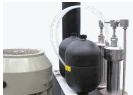
Acumulador de azoto para a gestão do circuito de retorno dos cilindros hidráulicos.
